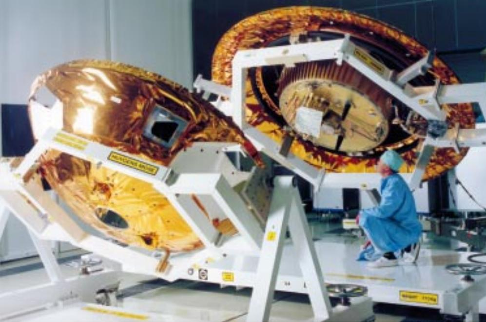
Abb. 5: Das Flugmodell von Huygens im Reinraum der DASA kurz vor dem Aufsetzen des hinteren Hitzeschildes (links). Rechts von der Bildmitte ist das »Descent Module« zu erkennen, welches von einem sechseckigen Halterahmen umgeben ist.
